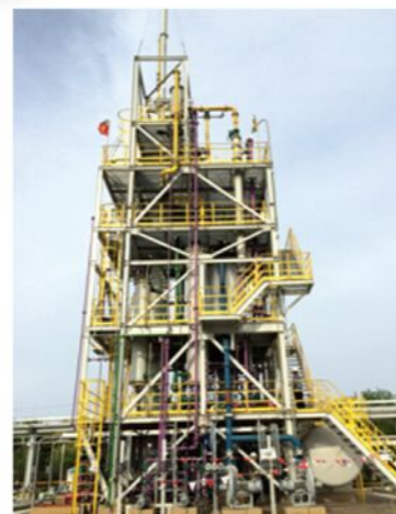
中化蓝天霍尼韦尔新材料有限公司含氟废气处理装置 Processing unit of waste gas containing fluoride Sinochem Blue Sky Honeywell New Materials Co., Ltd
