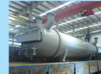
硫冷凝器 Sulfur condenser
